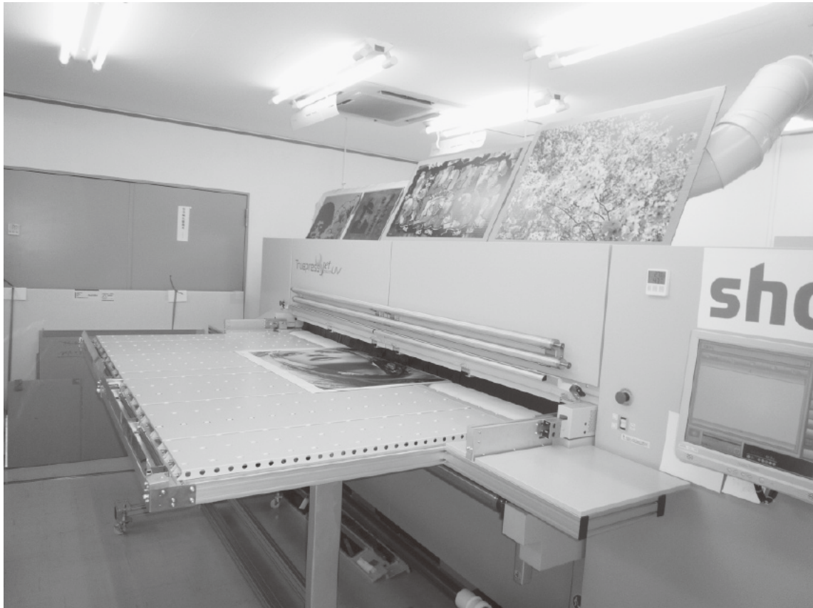
多様な素材に対応するUVインクジェットプリンター
